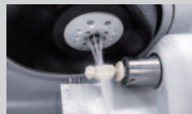
▲ カスタムアバットメントまで対応したミリングが院内で完結
