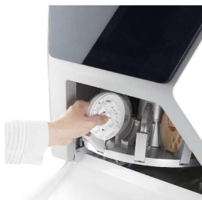
片手でディスク固定を可能にした DirectDiskTechnology
