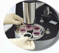
ディッシュをステージごと取り外してクリーンベンチ内で培地交換や薬剤添加が行えます。作業後に再度ステージをセットすることで、**同じポイントを継続して観察・撮影**できます。
